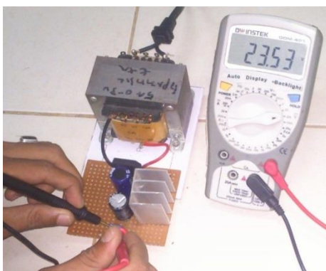
Gambar 3.1 Hasil pengujian pada Power supply +24V
