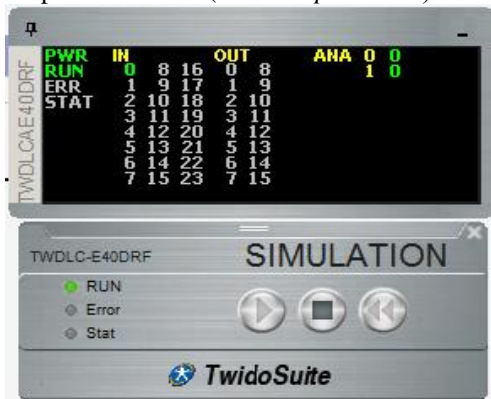
Gambar 3.7 Kondisi output program saat alamat input I0.0 aktif
