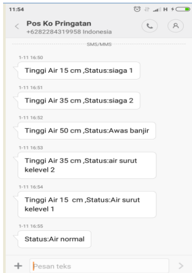
Gambar 8. Hasil pengujian pengiriman SMS
