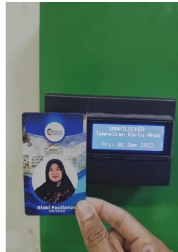
Gambar 6. Percobaan membuka loker dengan ID terdaftar
