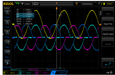
Gambar 9. Pengukuran waktu tunda 2.5 ms ( \alpha=45^\circ )
