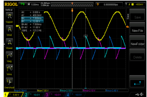
Gambar 13. Pengukuran waktu tunda 7,5 ms ( \alpha=135^\circ )
