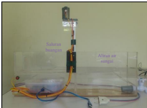
Gambar 6. Purwarupa alat pengendalian pintu saluran air
