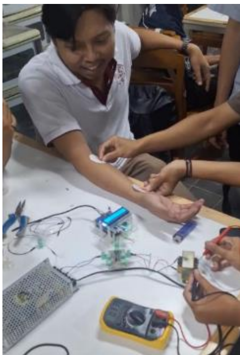
Gambar 7. Penulis melakukan ujicoba 120 Hz menimbulkan kontraksi otot yang terasa seperti di pijat. 80-120 Hz adalah frekuensi yang paling optimal untuk untuk penulis.
