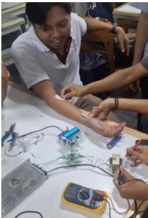
**Gambar 7.** Penulis melakukan ujicoba 120 Hz menimbulkan kontraksi otot yang terasa seperti di pijat. 80-120 Hz adalah frekuensi yang paling optimal untuk penulis.
