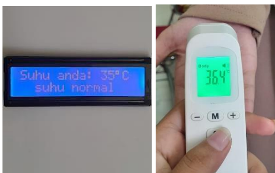
Gambar 8. Hasil pengukuran Sensor Suhu MLX90614 dan Thermogun Infrared Digital
