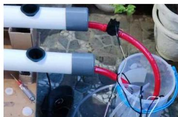
Gambar 11. Pengukuran kecepatan aliran air dengan sensor *Waterflow*
