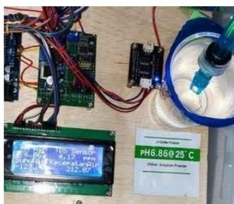
**Gambar 7.** Pengujian sensor pH meter pada pH air 6.86
