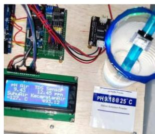
**Gambar 8.** Pengujian dengan sensor pH meter pada pH air 9.18
