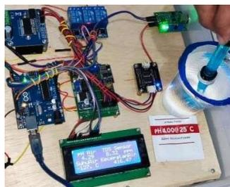
**Gambar 6.** Pengujian sensor pH meter pada pH air 4.00
