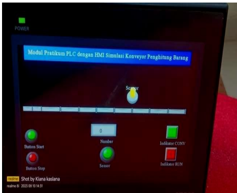
Gambar 10. Design konveyor pada layar HMI touchscreen
