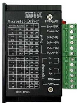
Gambar 5. Pengaturan pulse dan arus motor stepper TB6600
