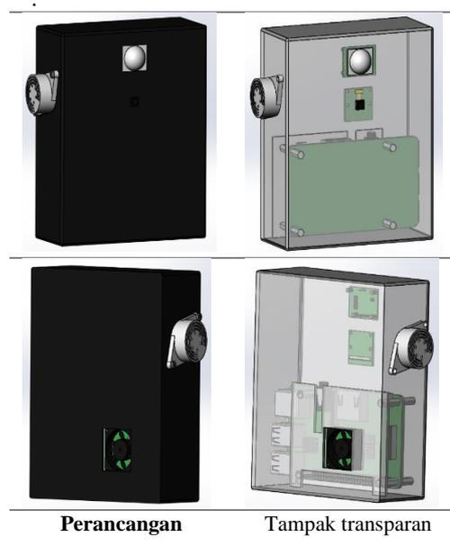
Gambar 2. Perancangan bentuk alat sistem keamanan ruangan berbasis IoT
