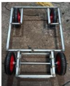
Gambar 8. Perakitan kerangka pada Alat penyapu pinggir jalan ( Roadside Sweeper ).
