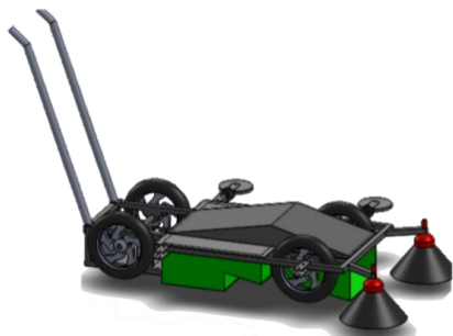
Gambar 7. Perancangan kerangka keseluruhan Alat Roadside Sweeper
