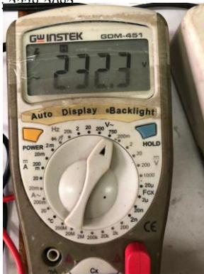
**Gambar 6.** Hasil pengujian tegangan sumber PLN menggunakan multimeter
