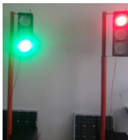
Gambar 10. Traffic Ligth Portable menggunakan RF wireless
