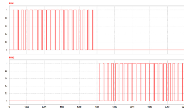
Gambar 7. Gelombang PWM 1 dan PWM 2
