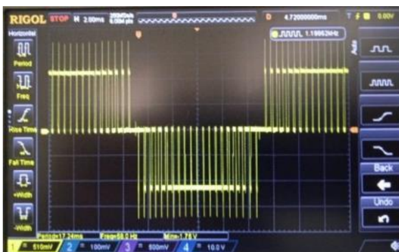
Gambar 12. Output Setelah Melewati H-Bridge
