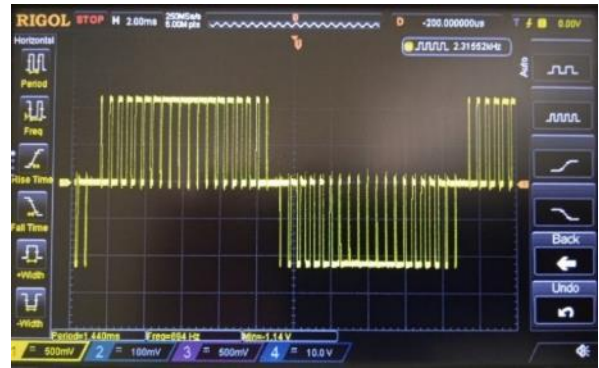
Gambar 13. Output Setelah Melewati H-Bridge dan Induktor
