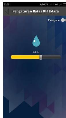
Gambar 10. Tampilan layar pengaturan batas kelembaban udara
