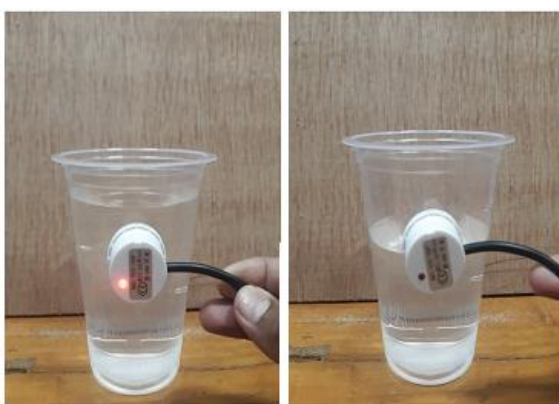
(a) Sensor mendeteksi air (b) Sensor tidak mendeteksi air Gambar 7. Pengujian sensor xkc-y25
